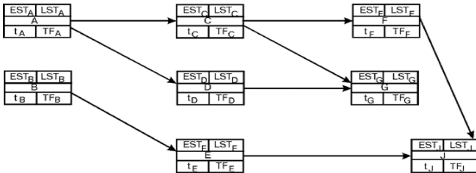
Рис. 2. Схема маркування вершин сіткового графіка моделі типу AoN
